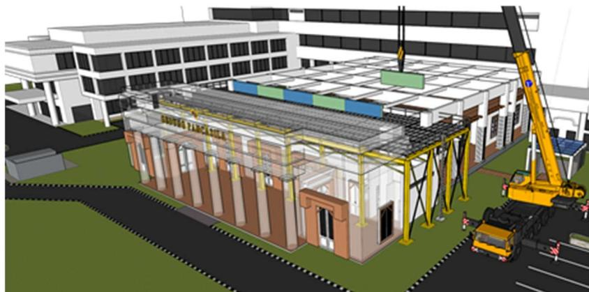
Ilustrasi pengangkatan segmentasi balok. Mekanisme pengangkatan segmen balok menggunakan mobile crane dengan memotong balok prategang menjadi beberapa bagian.
